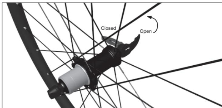
**ATTENZIONE:** Regolando manualmente la forza di chiusura della leva fare attenzione a non svitare o avvitare troppo il dado. Una rotazione pari a ½ giro può determinare la non chiusura o un eccessivo bloccaggio della ruota. Una regolazione non corretta della chiusura della ruota può causare incidenti e gravi danni all'utilizzatore.
